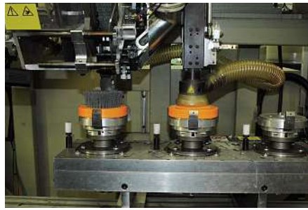
Bild 2: Anderlon-Borsten werden in CNC-Automaten im Bürstenkörper verankert.
