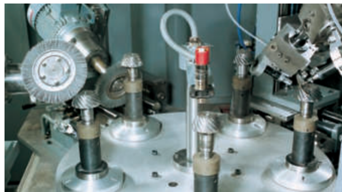
Die Rundtisch-Entgratmaschine mit zwei Vorschleif- und zwei Bürstenstationen.
