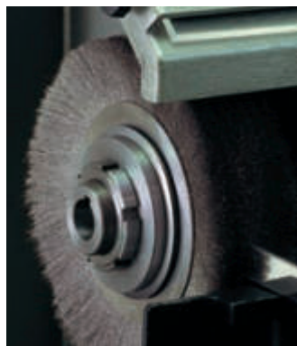
Schnittkanten-entgraten von Rohr-Abschnitten auf einer Tisch-entgratmaschine.
