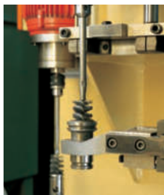
Eine Innenbürste entgratet Querbohrungen in einem Ventilkörper.
