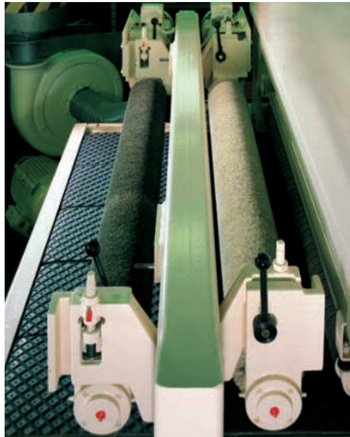
Lackzwischen-schliff von grundierten Holzoberflächen mit Spiralwalzenbürsten mit ANDERLON-Schleifborsten und nachgeschalteter Entstaubungsbürste ohne elektrostatische Aufladung
