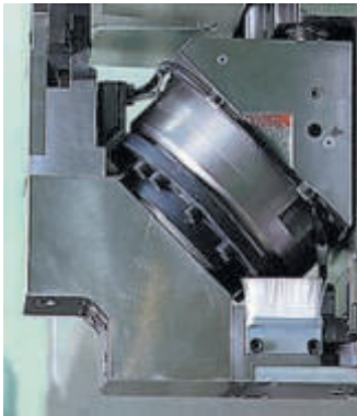
Abstreifen von Spänen an Spannwerkzeugen.
