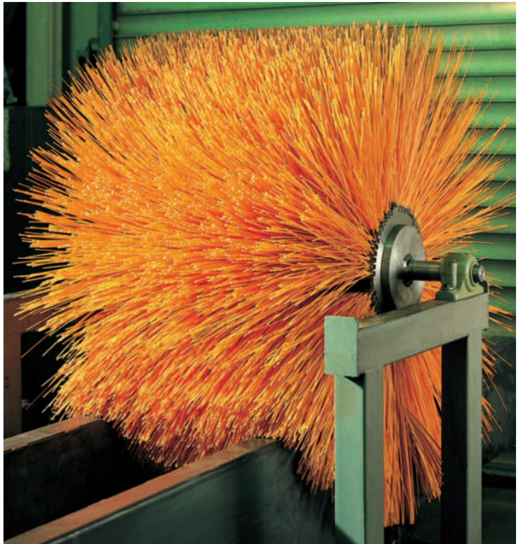
Entfernen der Strahlmittel auf Profilen in Durchlauf-Schleuderstrahlanlagen
