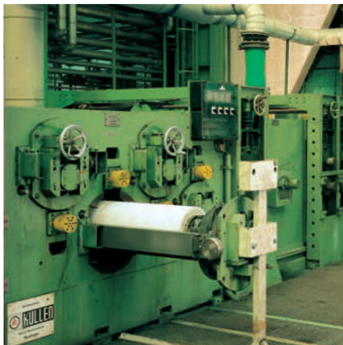
Bürstmaschine mit ausgezogenem Schnellwechselsystem für die Walzenbürsten in einer Reinigungslinie
