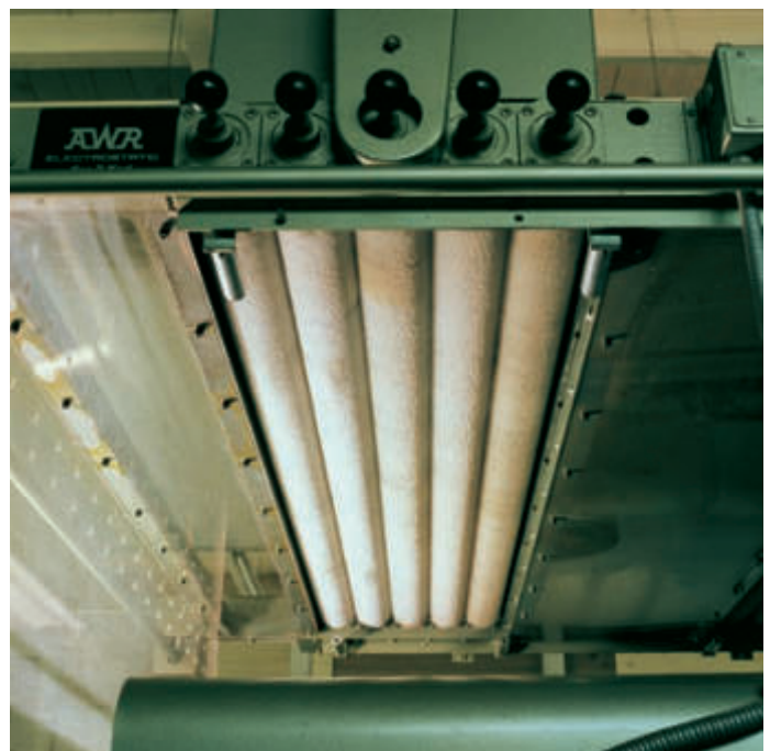
Walzenbürsten verteilen die Flockmasse in Textil-Beflockungsmaschinen
