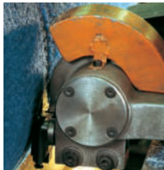
Der Abschervorgang an einer Walzenbürste
