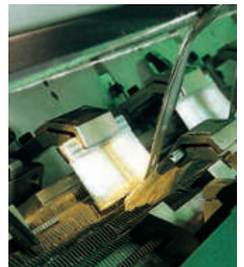
Damit die Produkti- on nie den Faden verliert: Bürsten öffnen und schließen Nadeln in Strickmaschinen.
