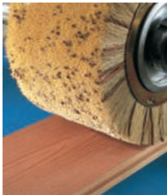
Poren reinigen und vertreiben der Beize durch Walzenbürsten mit Mischbesatz aus Pflanzenfasern und Lederstreifen
