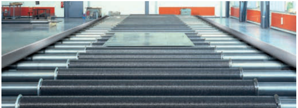
KULLEN Transportrollenbürsten für Aluminium-Durchlaufglühöfen werden grundsätzlich in einer Testlinie auf ihre Tracking-Eigenschaften geprüft.
