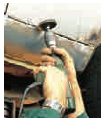
Schweißnahtbearbeitung mit einer Delta Schafrundbürste.
