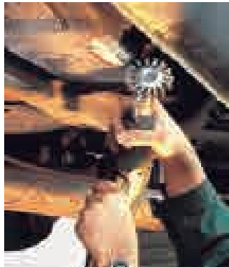
Entfernen von Unterbodenschutz mit einer Ultra Schaftgrundbürste.
