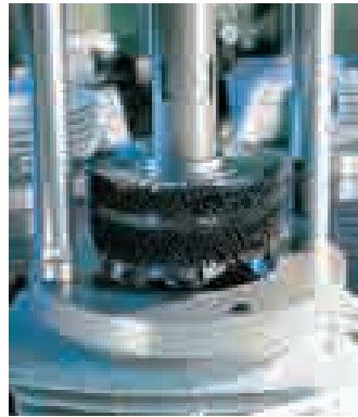
Zwei Alpha Einzel-scheiben-Bürsten honen einen Zylinderkopf.
