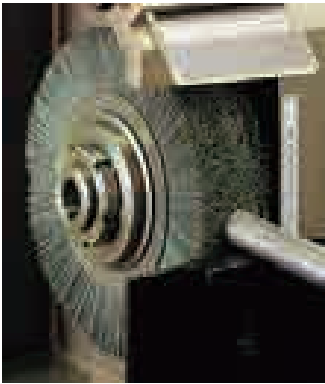
Schnittkanten-entgraten von Rohr-Abschnitten auf einer Tisch-entgratmaschine.
