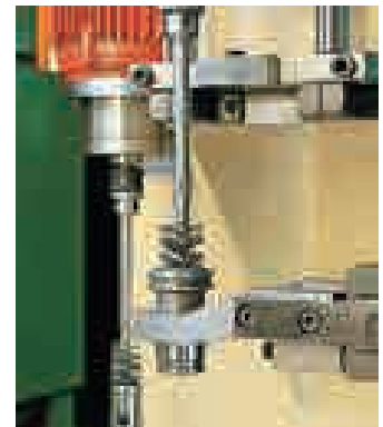
Eine Innenbürste entgratet Querbohrungen in einem Ventilkörper.
